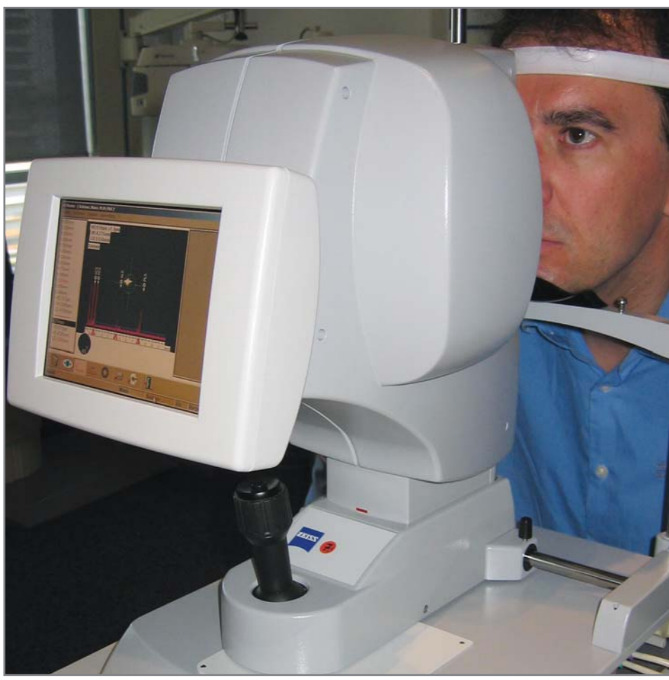
Abb. 1: ACMaster ® von Carl Zeiss Meditec, Jena. Laserinterferometer für die vorderen Augenabschnitte (Hornhautvorderfläche bis Linsenrückfläche).
